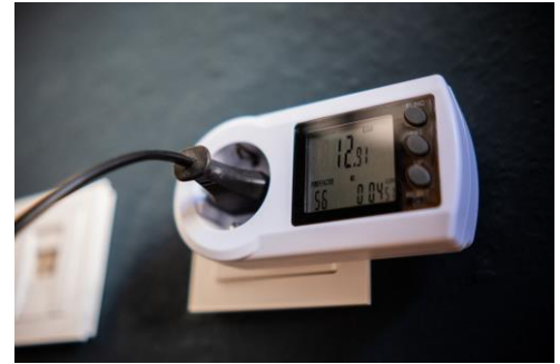
Abbildung 39: Strommessgerät als Adapter zwischen Steckdose und Stecker. © AdobeStock_Robert Poorten
